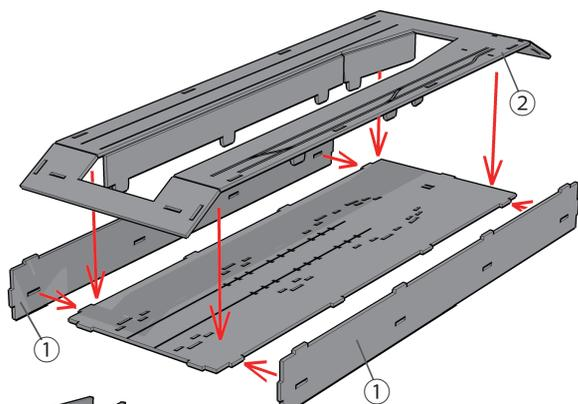
2. 付属のヘラや爪楊枝などで接着剤を付けて①～⑥の順にパーツを組み立てる。
